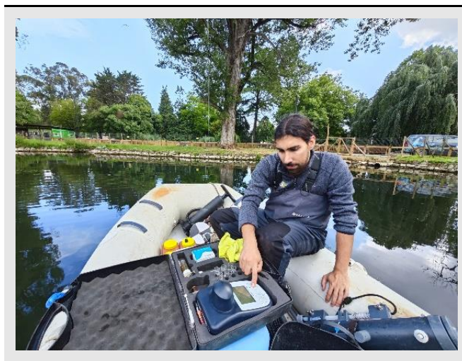
Imagen 2.3.2.1. Medición de la alcalinidad por medio del fotómetro portátil Palintest P7100.
