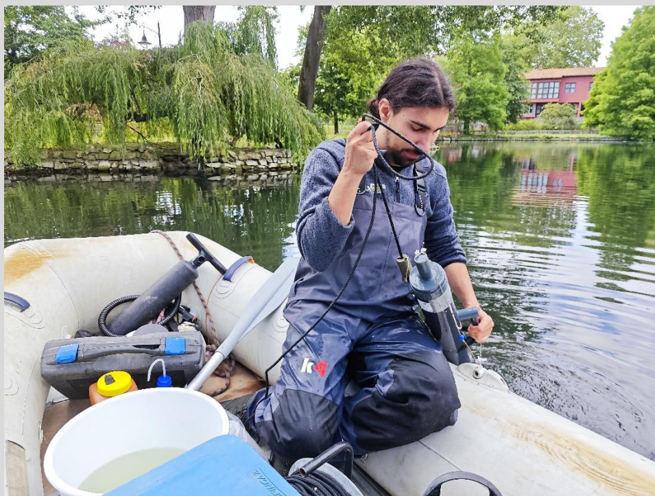
Fotografía 4. Técnico de TAXUS llevando a cabo la toma de muestra de agua integrada mediante botella Niskin en la Estación 2 durante la jornada de campo. (12/06/2024).
