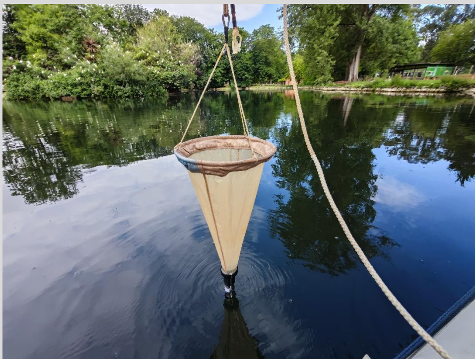
Fotografía 7. Detalle de la red de muestreo de fitoplancton empleada en la caracterización de las distintas estaciones muestreadas.
