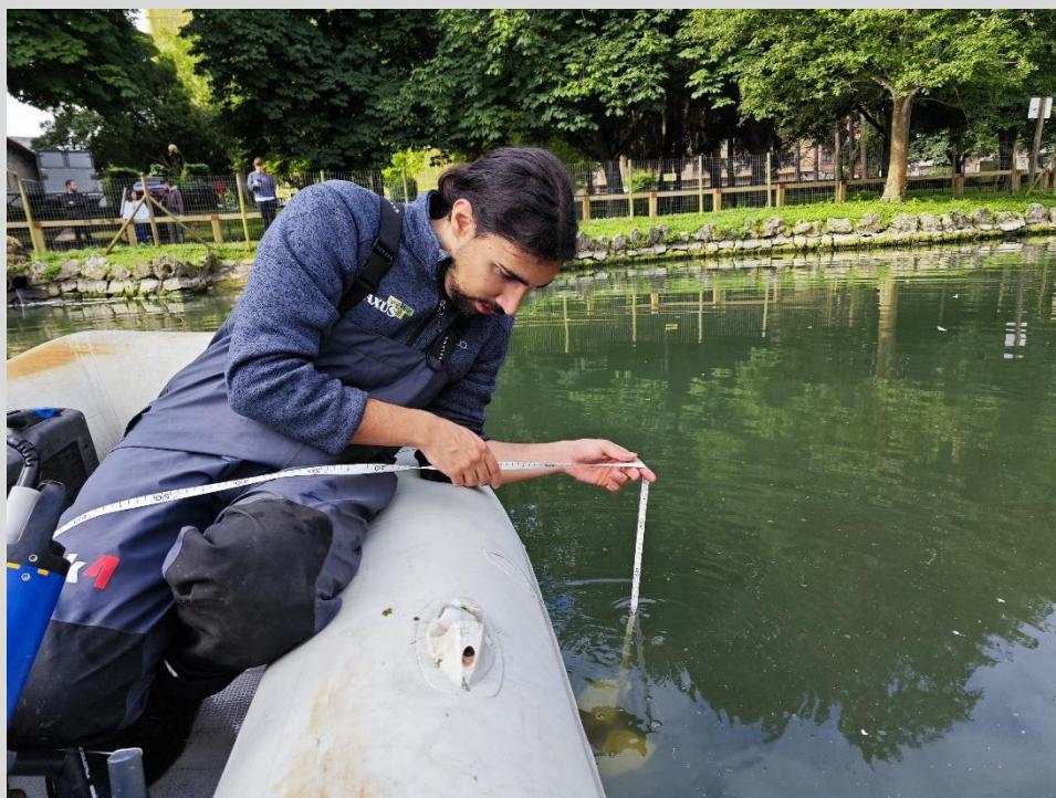
Fotografía 5. Técnico de TAXUS llevando a cabo la medición de transparencia mediante Disco de Secchi en la Estación 1 durante la jornada de campo. (12/06/2024).
