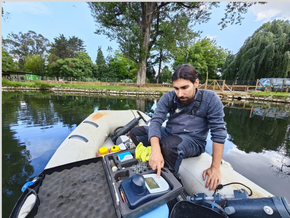
Fotografía 6. Técnico de TAXUS llevando a cabo la medición de la alcalinidad del agua en la Estación 2 durante el muestreo llevado a cabo el 12 de junio de 2024.
